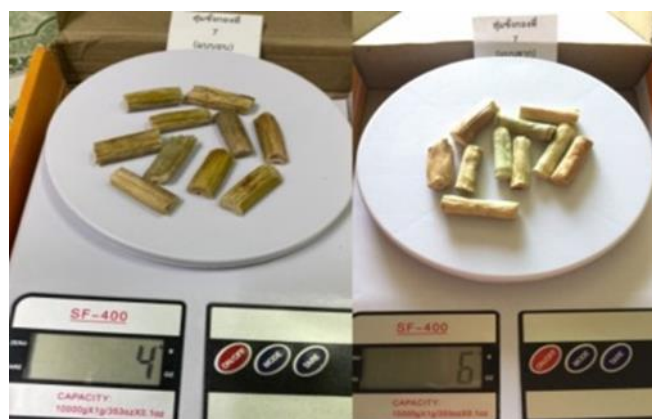
รูปที่ 4 ชั่งน้ำหนักระหว่างผักตบชวาแบบอบแห้งกับแบบตากแดด
