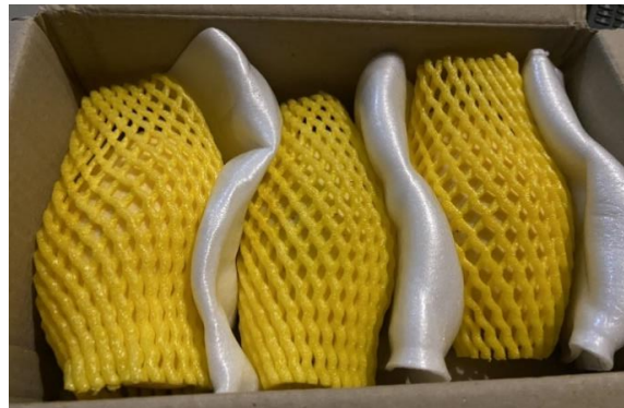
รูปที่ 5 กล่องกระดาษลูกฟูกกับโฟมตาข่ายคั่นด้วยโฟม
