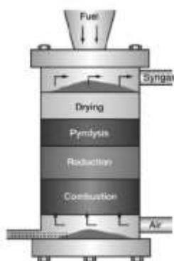
รูปที่ 1 เครื่องผลิตแก๊สเชื้อเพลิงแบบไหลขึ้น (updraft gasifier)
