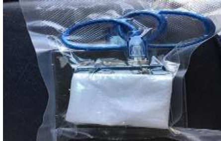
รูปที่ 14 GPS ที่บรรจุอยู่ในถุงสูญญากาศก่อนนำไปติดที่ฟუნ
