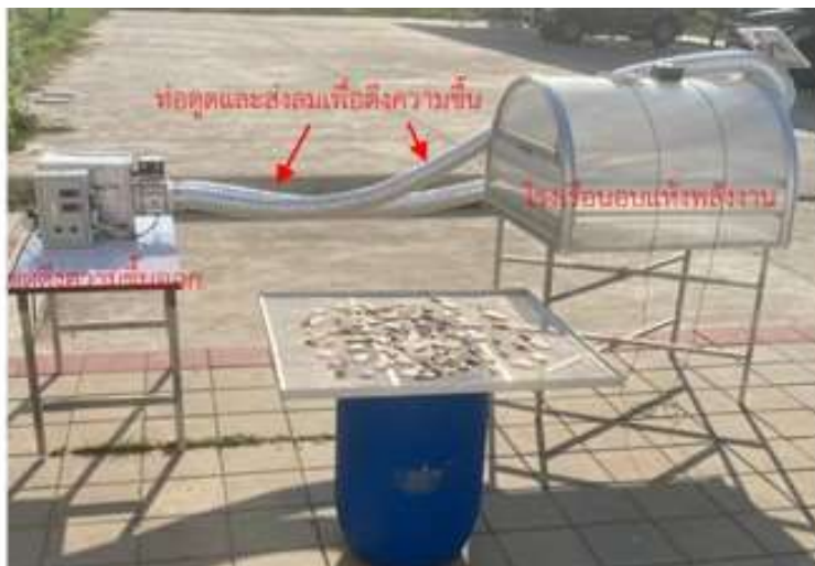
รูปที่ 3 ชุดทดสอบโรงเรือนอบแห้งพลังงานแสงอาทิตย์แบบมีระบบตั้งความถี่ขึ้นออก
