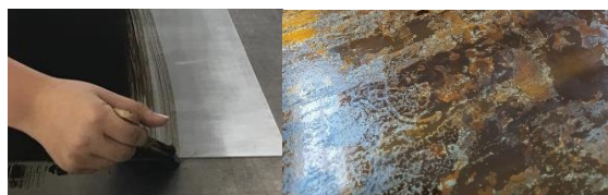
รูปที่ 7 ขั้นตอนการทาวานิชดำหลังจากทำพื้นผิวเสร็จแล้ว
