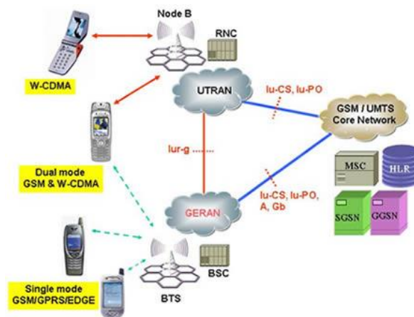
ภาพที่ 4.10 การทำงานร่วมกันระหว่างเครือข่าย UMTS และเครือข่าย GSM/GPRS/EDGE
