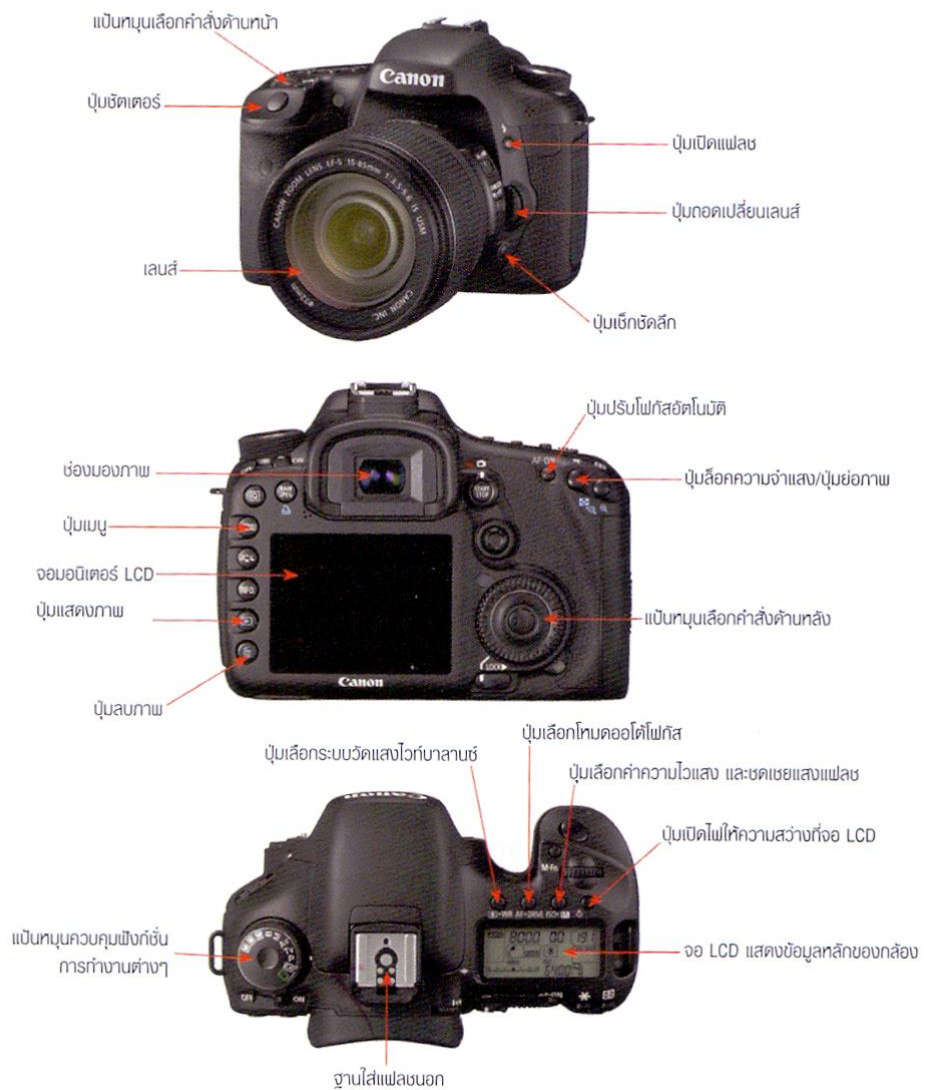
ตัวอย่างส่วนประกอบที่สำคัญของกล้อง SLR ในระบบดิจิทัล
