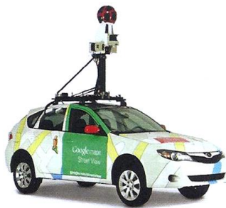
▲ รถยนต์ที่มีอุปกรณ์เก็บภาพถ่าย 360 องศา สำหรับ Street View
