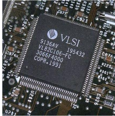
ภาพที่ 1.27 VLSI (Very Large Scale Integrated)
